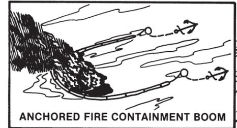
**ANCHORED FIRE CONTAINMENT BOOM**
